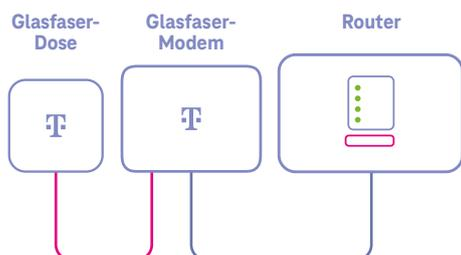
Die Glasfaser endet in der Glasfaser-Dose. Die Glasfaser-Dose stellt den Abschlusspunkt des Glasfaser-Netzes der Telekom dar. An die Glasfaser-Dose wird das Glasfaser-Modem oder der glasfasertaugliche Router mit integriertem Modem angeschlossen.
